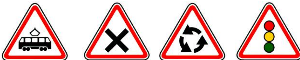
1.5 Пересечение трамвайной линией 1.6 Пересечение равнозначных дорог 1.7 Пересечение с круговым движением 1.8 Светофорное регулирование
